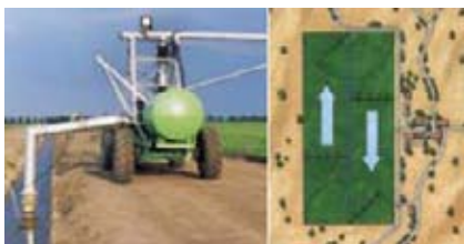
CENTERLINER/LINESTAR - centro móvel, desloca-se de forma linear e circular. Alimentação por mangueira ou canal.
